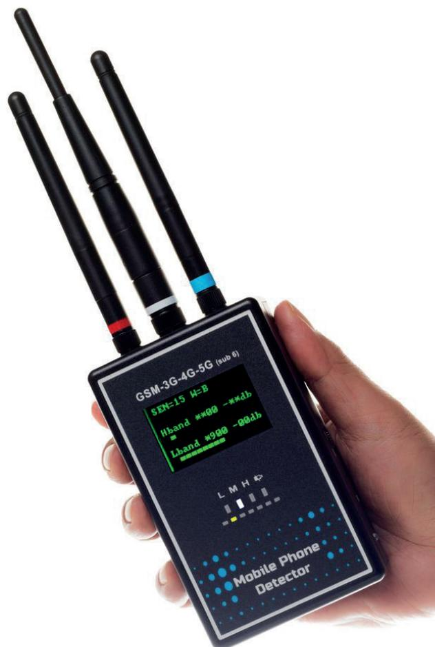
Il Rilevatore Portatile di Telefoni Cellulari Securscan ST168-5G è un dispositivo avanzato progettato per rilevare e monitorare le attività di telefoni cellulari e dispositivi trasmettenti, in ambienti sensibili.
